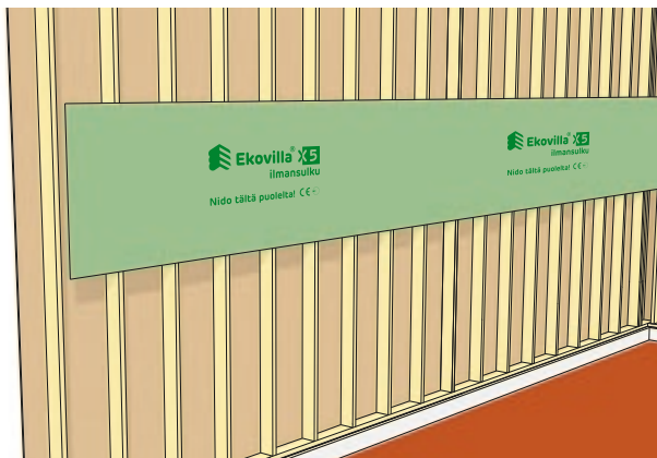
1. Asenna ilmansulkukaista välipohjan kohdalle ukoseinärunkoon ympäri talon.
