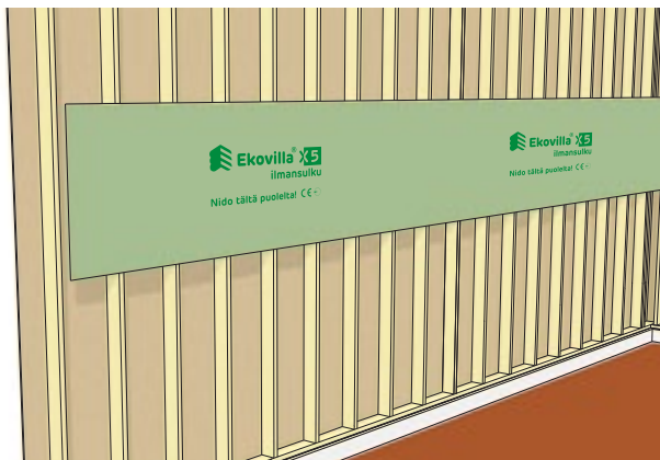
1. Asenna ilmansulkukaista välipohjan kohdalle ukoseinärunkoon ympäri talon.
